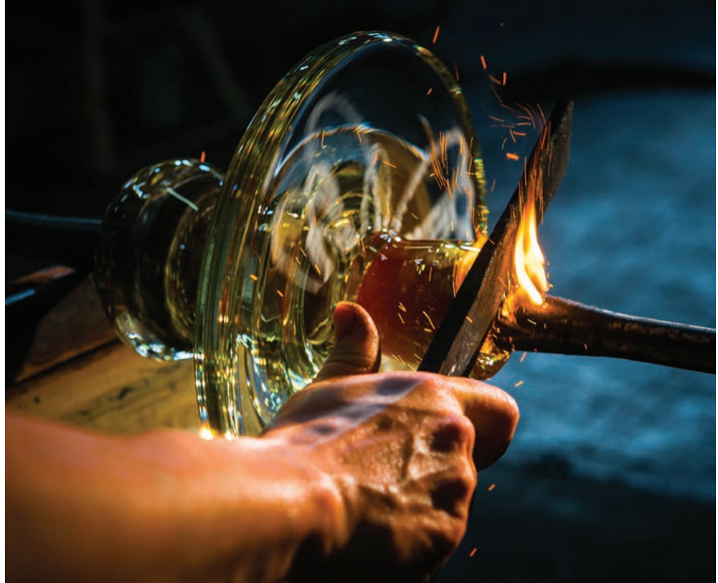
→ INSTANT DÉLICAT : LE MOMENT OÙ LE CRISTAL EN FUSION DOIT ÊTRE SÉPARÉ DE LA CANNE PAR LAQUELLE IL A ÉTÉ SOUFFLÉ. A DELICATE OPERATION: THE MOMENT WHEN THE MOLTEN CRYSTAL HAS TO BE SEPARATED FROM THE ROD THROUGH WHICH IT HAS BEEN BLOWN.
